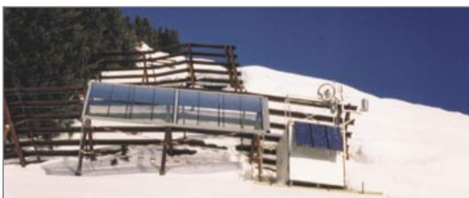
Test du CEP en milieu alpin (Les Diablerets), technologie SunAlpes, voir page 2
