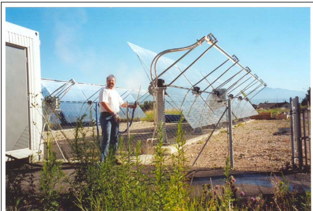
Photo 1-6-a: Le CEP (Concentrateur Solaire Extra-Plat), élément clé de la cogénération solaire promue par – SunAlpes avec le soutien de l’OFEN).
