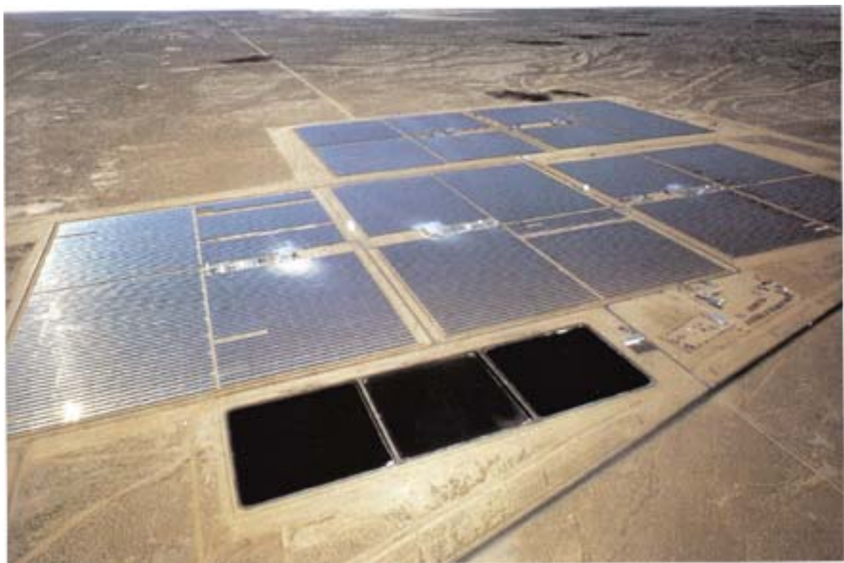
Photo 1-1-a : 5 centrales solaires à vapeur de type SEGS, de 30 MWe chacune, utilisant des concentrateurs paraboliques de type LS3 (SEGS 3-4 à Kramer Junction en Californie USA) http://www.fplenergy.com/portfolio/contents/segs_viii.shtml
